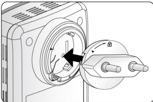
2. Controllare le istruzioni di blocco della clip. Per la “chiusura triangolare” fare riferimento al corretto diagramma.
