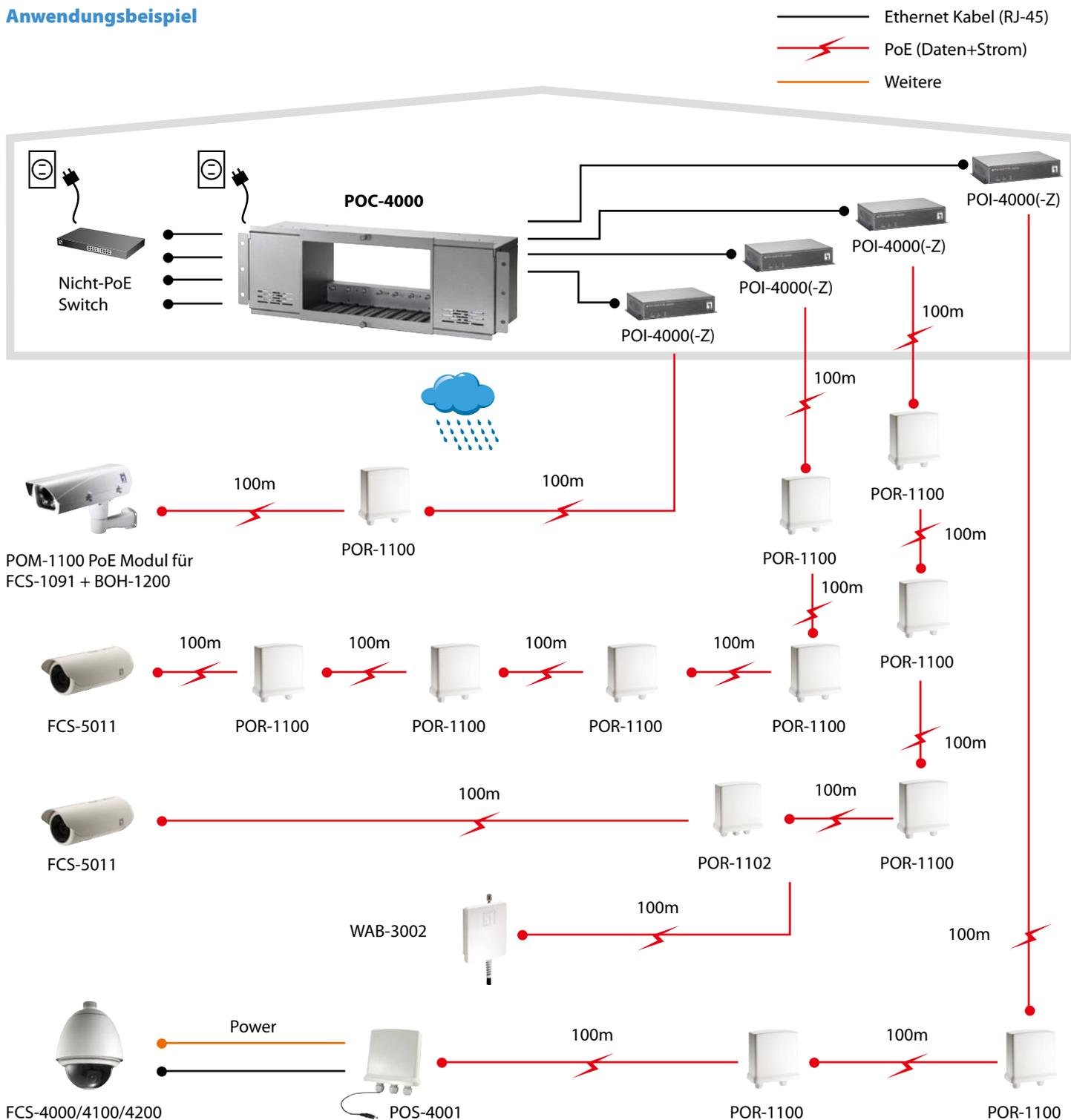
Hinweis: Diese Entfernungen sind typische Ergebnisse unter Verwendung von 18 ~ 19Ω 24 AWG Cat.5 Kabel.
